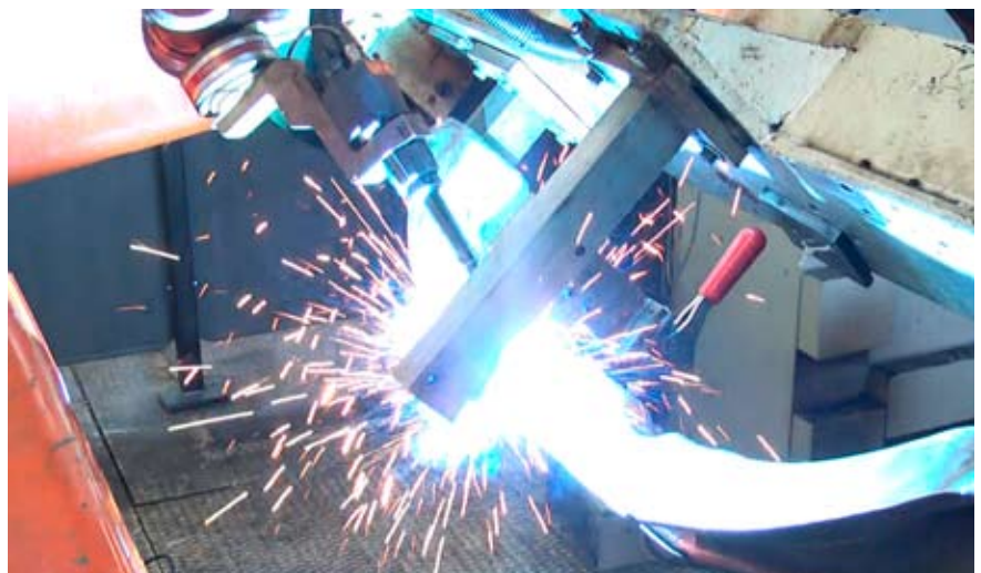
Fertigung von Achsträgern mit OK Tubrod 14.11 1,2 mm
